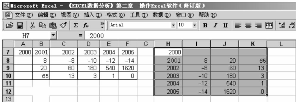
图 2—5 选择性粘贴“转置”结果示意图
